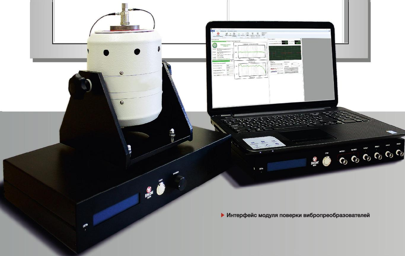
► Интерфейс модуля поверки вибропреобразователей
